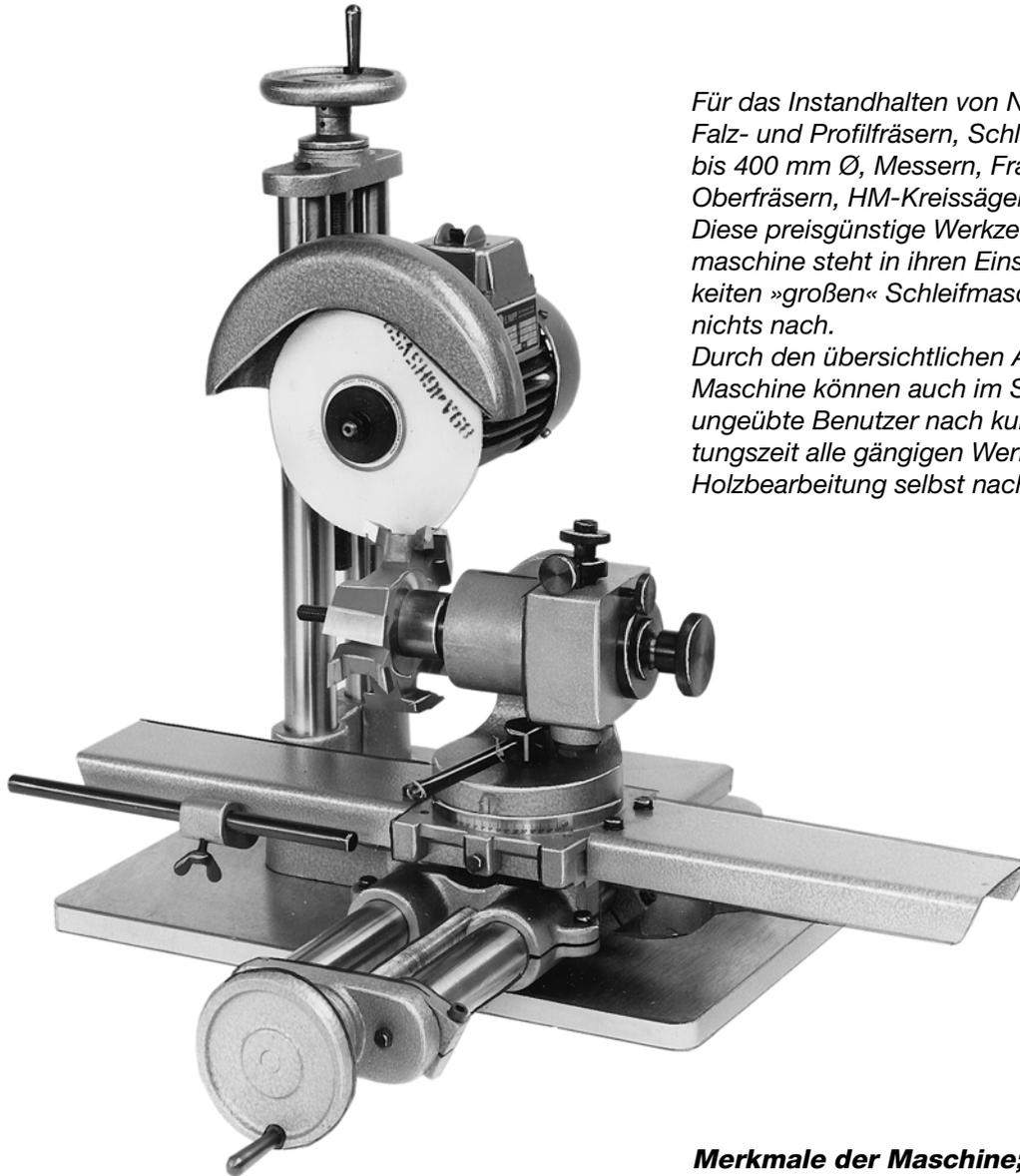
*Für das Instandhalten von Nut-, Füge-, Falz- und Profilfräsern, Schlitzscheiben bis 400 mm Ø, Messern, Fräsketten, Oberfräsern, HM-Kreissägeblätter etc. Diese preisgünstige Werkzeugschleifmaschine steht in ihren Einstellmöglichkeiten »großen« Schleifmaschinen in nichts nach.*
